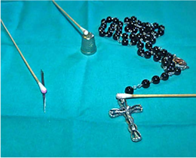
Figura 2. Test de dimetilglioxima en las agujas y dedal de costura y rosario. Este test se considera positivo si el algodón impregnado en la solución al entrar en contacto con el metal se tiñe de rojo, como se puede ver en la imagen para el caso de las agujas y el rosario.
